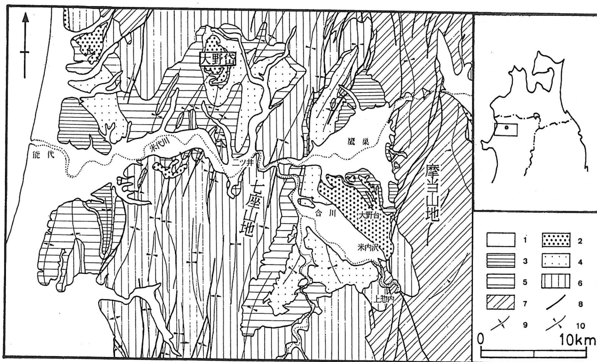
図1 米代川流域の地質図 大沢・須田(1978)を一部修正・簡略化 1: 沖積層, 低位・中位段丘堆積物 2: 高位段丘堆積物 3: 湯車層, 中沢層 4: 前山川層, 笹岡層 5: 小比内沢層, 天徳寺層 6: 藤琴川・岩谷層, 船川・女川層, 遠部・一通・大滝層 7: 早口川層以下 8: 断層 9: 背斜軸 10: 向斜軸
